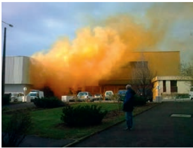
▲ Vapeurs nitreuses suite à l'introduction d'acide nitrique ( \text{HNO}_3 ) dans une cuve en acier noir (incompatibilité contenant/contenu).
